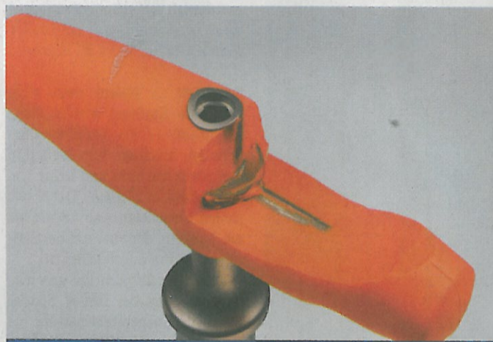
Abb. 2: Durch die Vulkanisierung entsteht bei den Instrumenten zwischen Kunststoffgriff und Metallschaft eine stabile, dichte Verbindung. Selbst eine Kapillarwirkung lässt sich so verhindern. (Quelle: Orange Spine GmbH)
